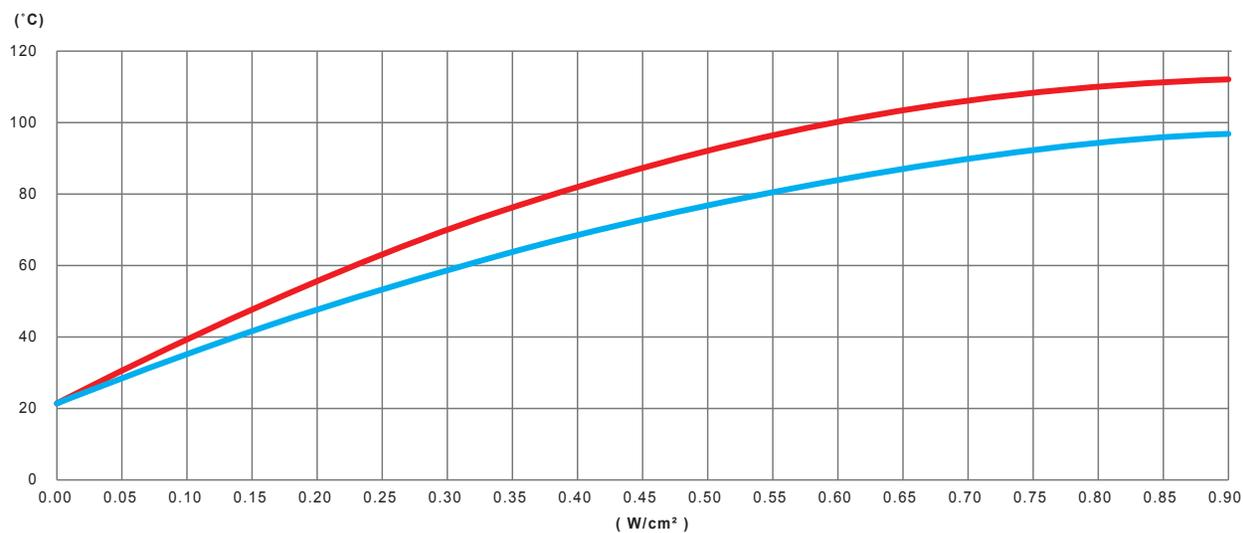
Variation, in function of the power in W/cm<sup>2</sup> of the silicone heating tape, of the temperature of the wall of a **tubo di acciaio inossidabile, riempito con acqua non circolante e non isolato termicamente.**
