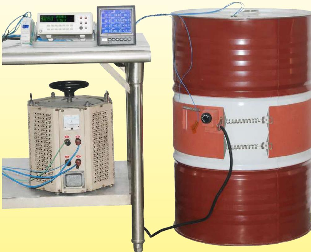
Variazione della temperatura rispetto al tempo di un fusto metallico da 220 litri, **riempito d'acqua**, riscaldato da un nastro riscaldante in silicone largo 200mm, senza isolamento termico, potenza **2250 W** (carico superficiale **0.75 W/cm<sup>2</sup>**).
