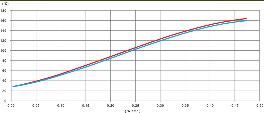
Variation, in function of the power in  $W/cm^2$  of the silicone heating tape, of the wall temperature of a **tubo di acciaio zincato vuoto, isolato termicamente da una schiuma di PVC-NBR di 20mm.**
