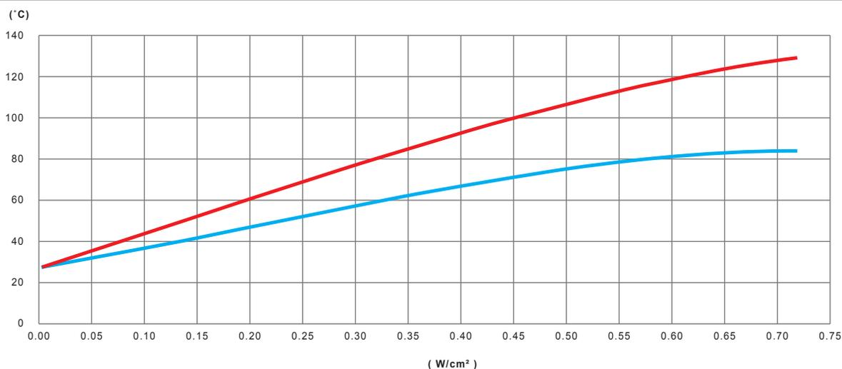
Variazione, in funzione della potenza in W/cm<sup>2</sup> del nastro riscaldante in silicone, della temperatura della parete di un tubo in PVC riempito con acqua non circolante, non isolato termicamente.
