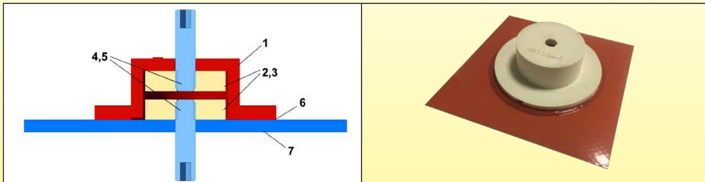
Attrezzatura utilizzata per i test comparativi (Superficie di incollaggio: 10cm<sup>2</sup>).
