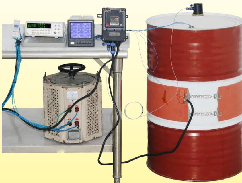
Variazione della temperatura nel tempo di un fusto metallico da 220 litri, riempito d'acqua, riscaldato da un nastro riscaldante in silicone largo 200mm, senza isolamento termico, potenza 2250 W (carico superficiale 0.75 W/cm<sup>2</sup>).
