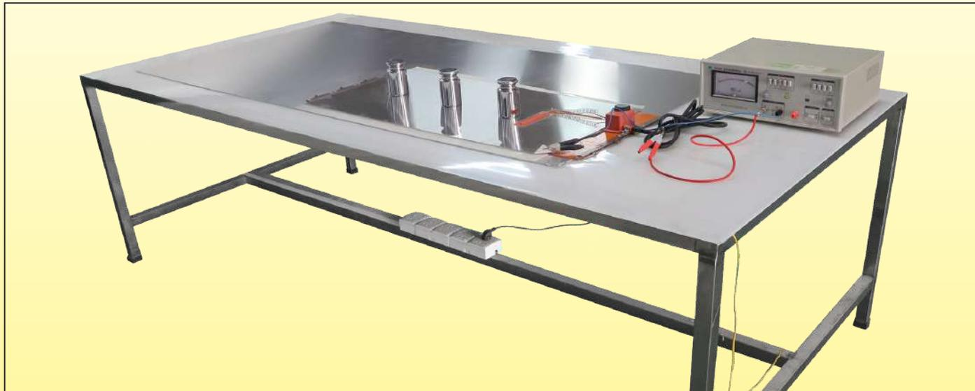
Dispositivo per la misurazione della resistenza di isolamento.
