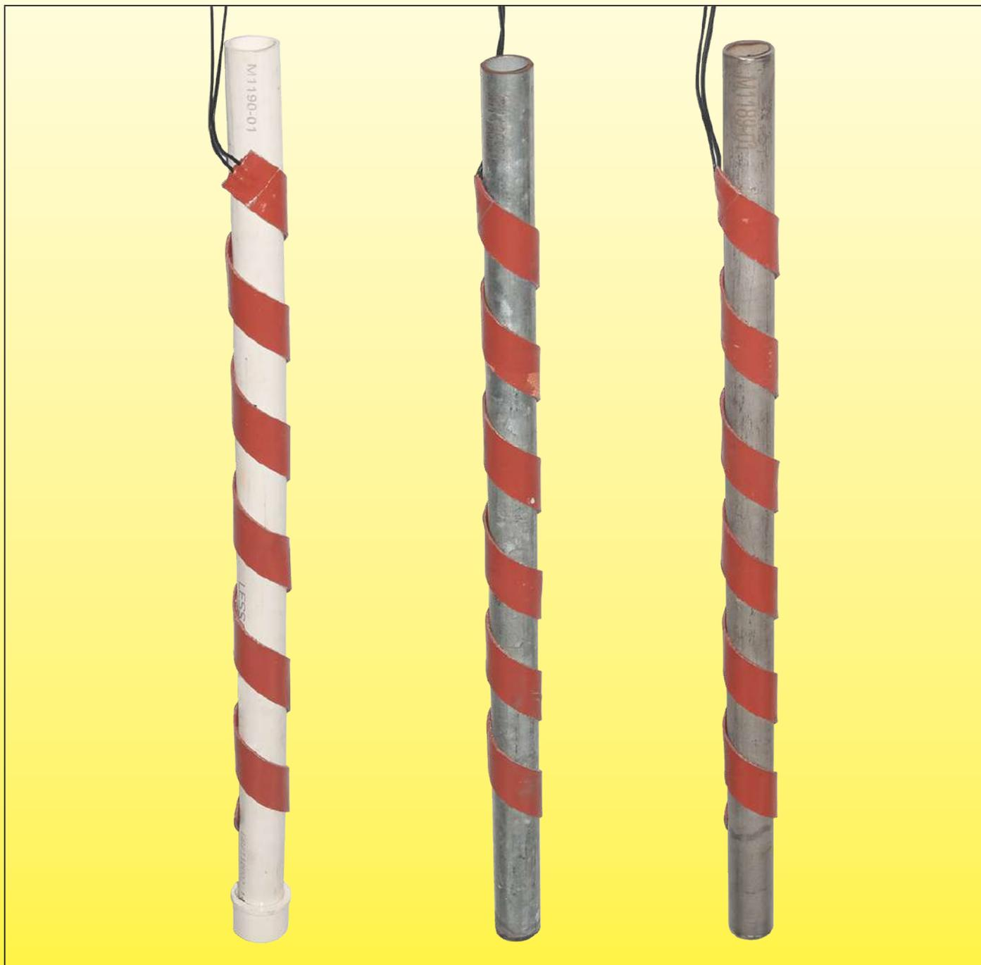
Condizioni dei test comparativi: Nastri riscaldanti in silicone avvolti su tubi di diametro esterno di 25mm, in PVC-U, acciaio zincato e acciaio inossidabile.
