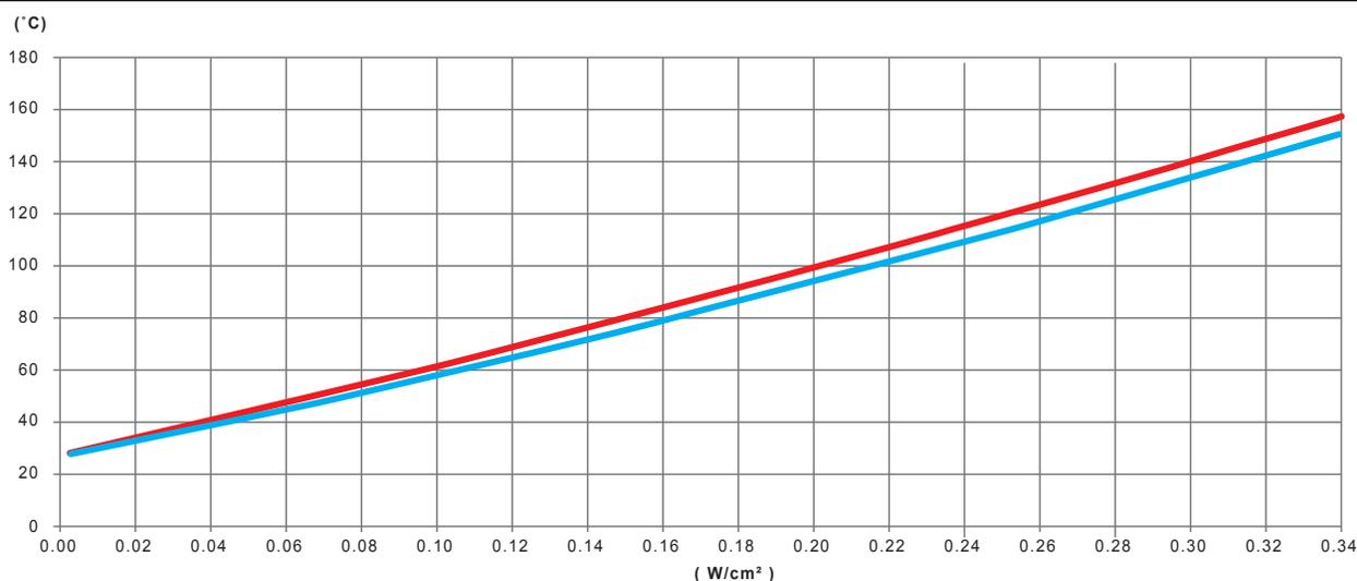
Variation, in function of the power in W/cm<sup>2</sup> of the silicone heating tape, of the temperature of the wall of a **tubo di acciaio inossidabile vuoto, isolato termicamente da 20mm di schiuma PVC-NBR**
