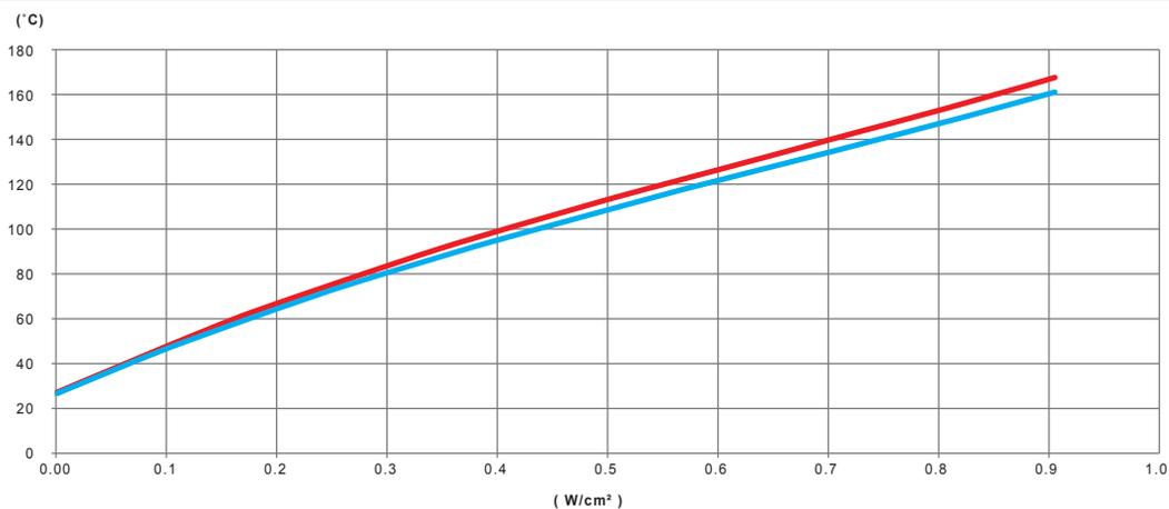
Variation, in function of the power in  $W/cm^2$  of the silicone heating tape, of the wall temperature of a **tubo di acciaio zincato vuoto, non isolato termicamente**
