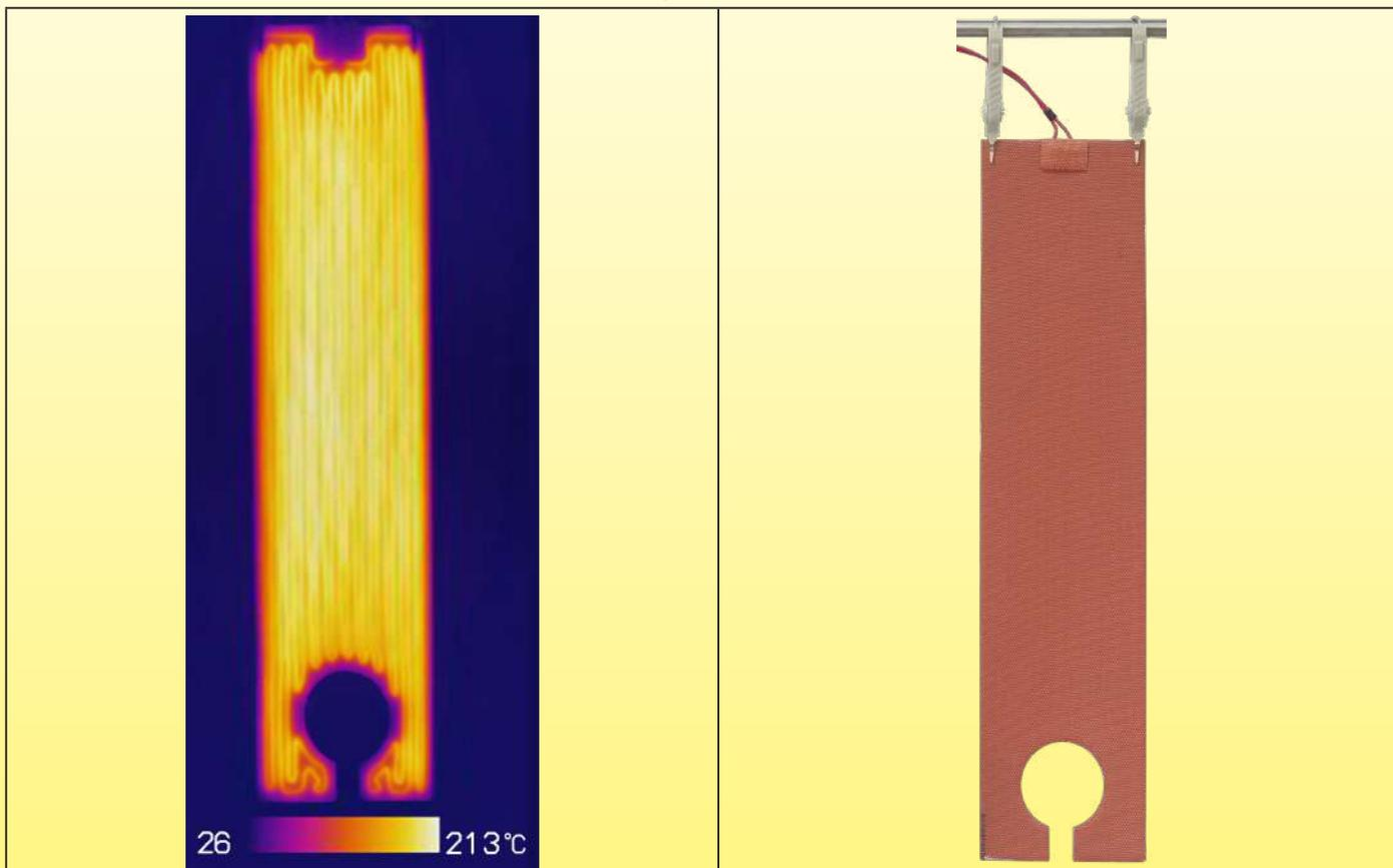
Immagine termografica di un riscaldatore in silicone piatto da 2.4mm con un carico di potenza superficiale di  $1W/cm^2$ , sospeso in aria calma, non fissato su una scheda, alla temperatura ambiente di  $25^{\circ}C$ . La temperatura superficiale raggiunge i  $213^{\circ}C$ , in prossimità della sua distruzione.
