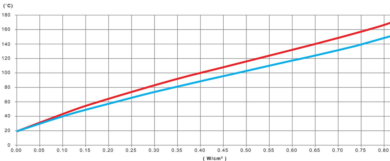
Variation, in function of the power in W/cm<sup>2</sup> of the silicone heating tape, of the temperature of the wall of a **tubo di acciaio inossidabile vuoto, non isolato termicamente**
