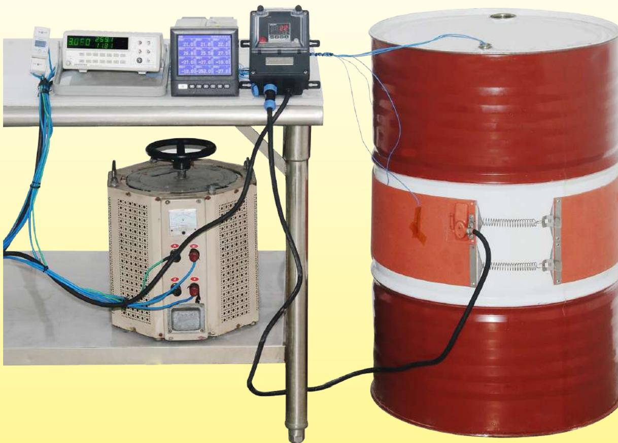
**Variazione della temperatura nel tempo di un fusto metallico da 220 litri, riempito d'acqua, riscaldato da un nastro riscaldante in silicone largo 200mm, senza isolamento termico, potenza 1500 W (carico superficiale 0.5 W/cm<sup>2</sup>).**
